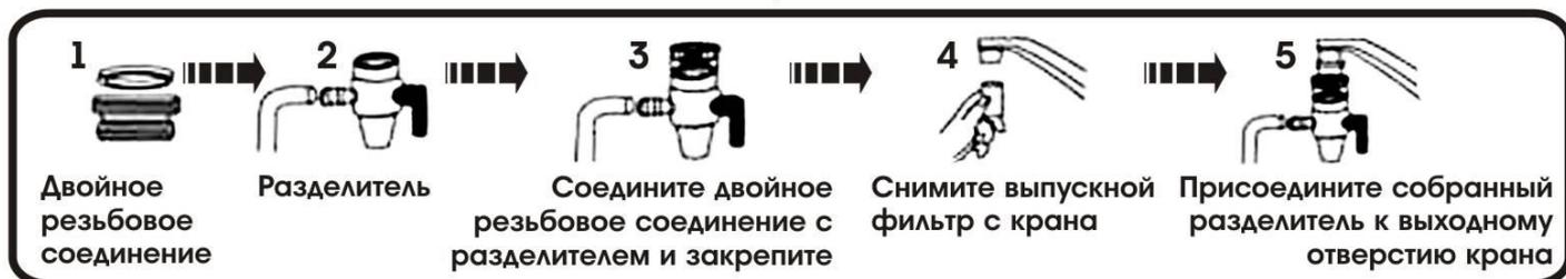
Если на кране имеется внешняя резьба, то производите установку следующим образом: (картинка 2 справа).
