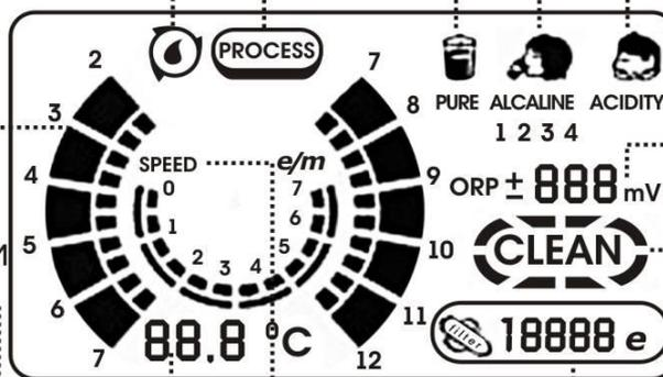
Лампочка индикатора – показывает щелочную, очищенную и кислую воду
